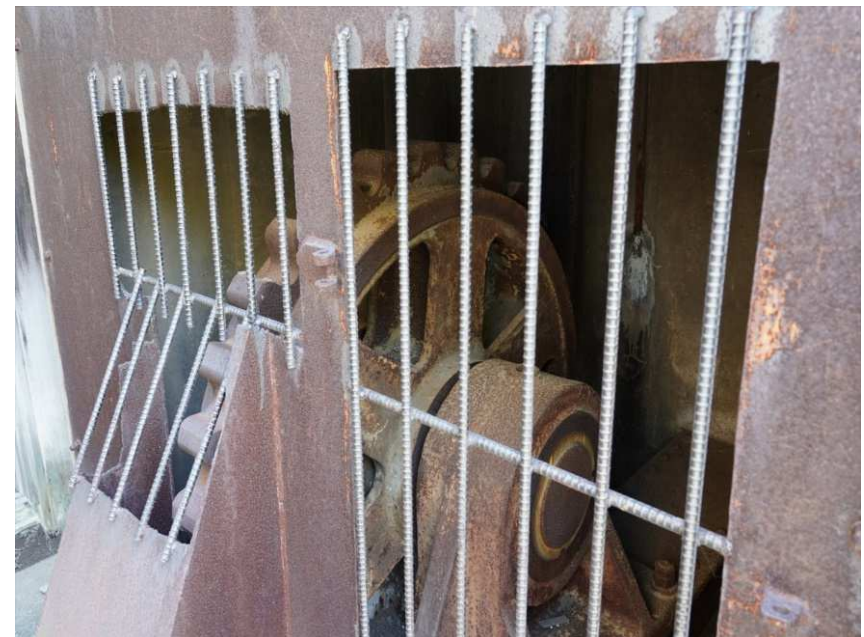
②現存する機械式巻き上げ機のスプロケットホイール(歯車)
